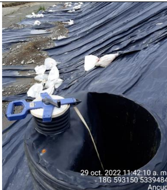
Fotografía N°18: Medición de Niveles de cámaras por Personal Municipal. Tomada: 29 de Octubre del 2022.
