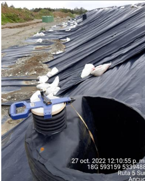
Fotografía N°16: Medición de Niveles de cámaras por Personal Municipal. Tomada: 27 de Octubre del 2022.
