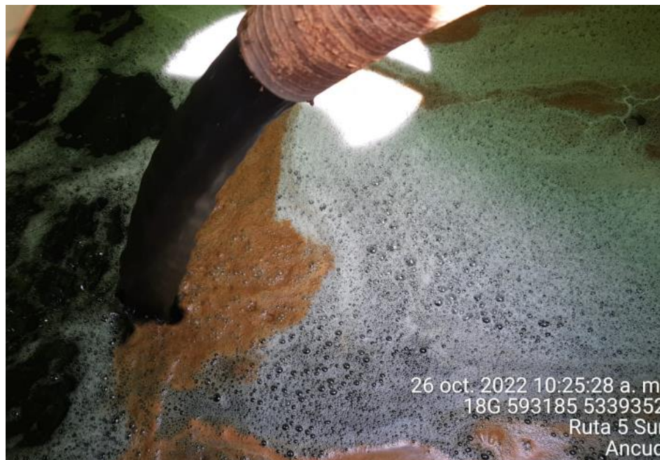
Fotografía N°5: Extracción de Lixiviados a estanque por personal municipal. Tomada: Miércoles 26 de Octubre del 2022.
