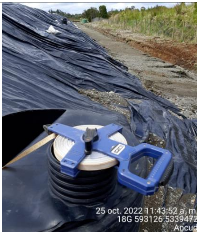
Fotografía N°14: Medición de Niveles de cámaras por Personal Municipal. Tomada: 25 de Octubre del 2022.
